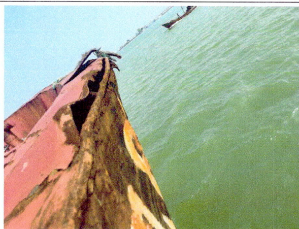
右舷舷墙受损变形
